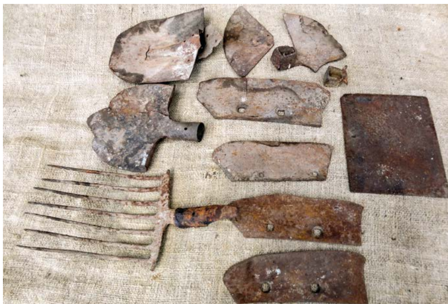
69. kép. Hidegkovács szerszámok: kőhányó villa, ásóvas, lapátvas, kapavas, ekevasak.
