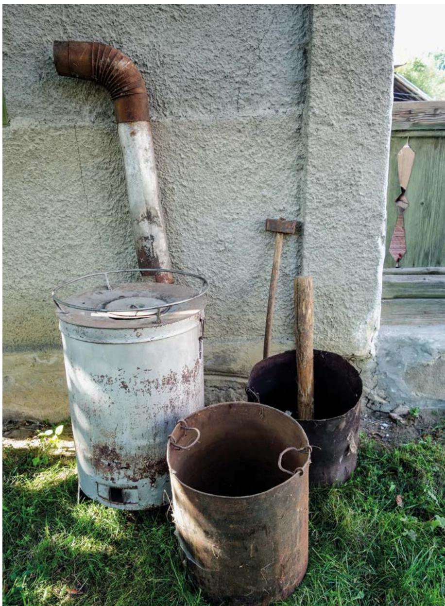
34. kép. A téli fűtésre használt mosztos(kályha) és tartozékai: kürtőcső , két mosztosbetét , mosztostőtő fa , és a moszt (fűrészpor) bedöngölésére szolgáló vasbot .
