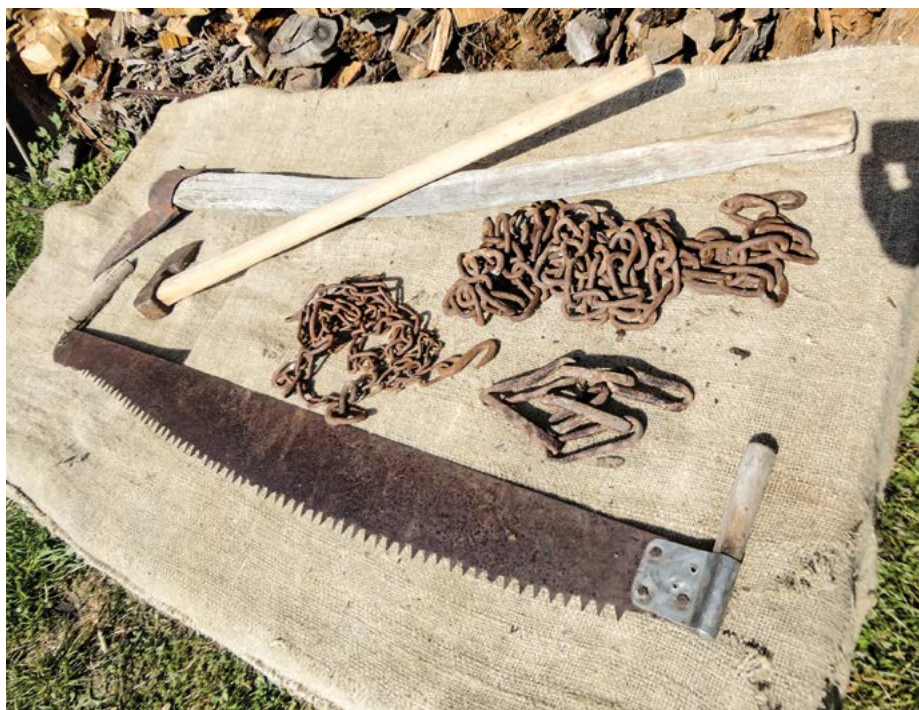
57. kép. Az erdőlés szerszámai: harcsafűrész, fészű, fahúzócsákán, erdőlő láncok.
