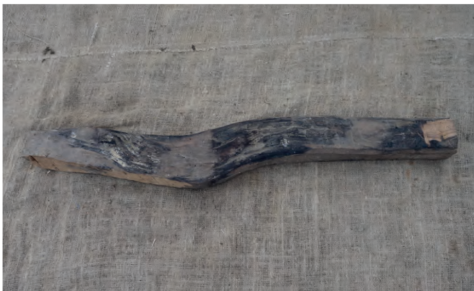
6–7. kép. Egy rosszul megjavított szekerelő és egy majdani új ágas egyik felének szánt bükkfadarab. A nyersen megfaragott szekéralkatrészt szalmával megégették, hogy erősebb legyen és ne hasadozzon.
