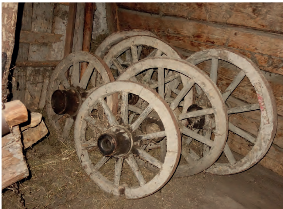
10. kép. Ráffal behúzott szekerkerekek, javításokkal.
