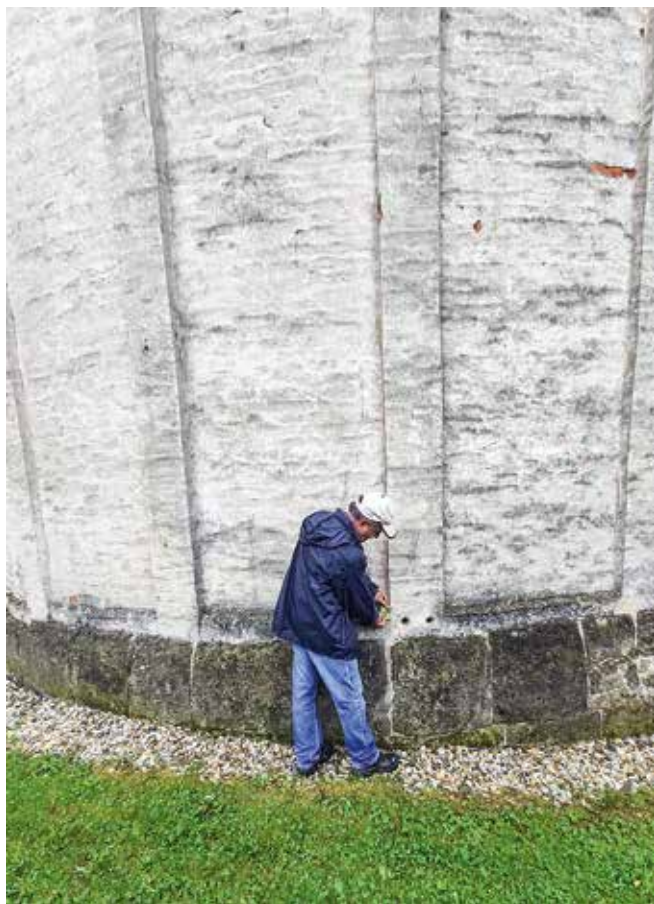
78. kép. Alsó lizéna-sarokhoz illesztett kártya mérése. A lizénák felső pontjait lézerfényvel irányoztuk
