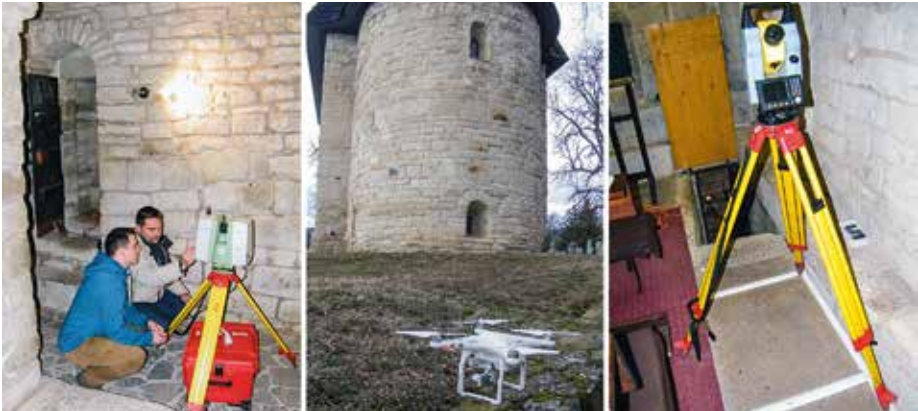
48. kép. Lézerszkennő, UAV (drón) és mérőállomás Tarnaszentmárián
