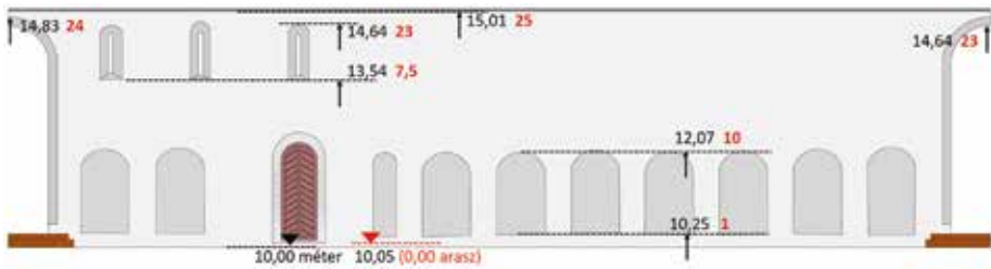
100. ábra. Magasságok a húrok mentén kiterített belső metszeten. Fekete: jelenlegi, 10 méternek felvett padlószinttől méterben; piros: 5 cm-rel emelt padlószinttől, araszban
