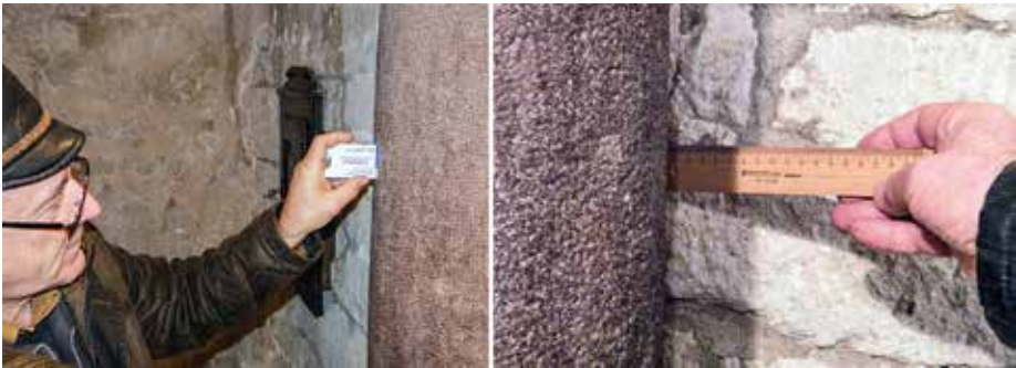
65. kép. Oszlop kerületi pontjának mérése kártyával és külponthoz
