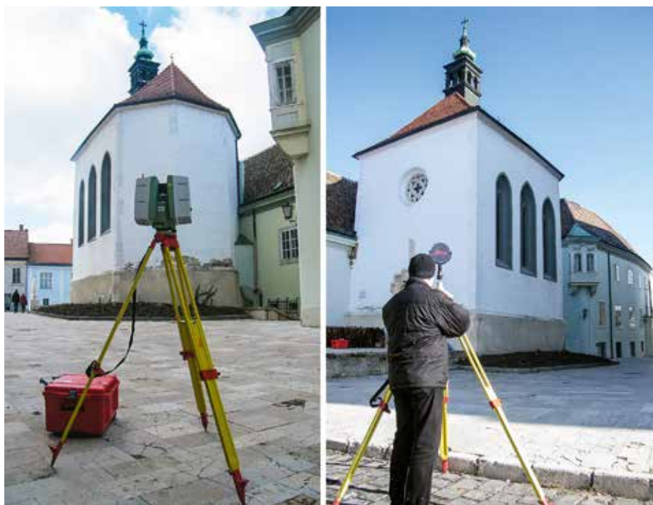
43. kép. A Leica C10 lézershakker és jeltárca az épületen kívüli 5-ös és 3-as ponton
