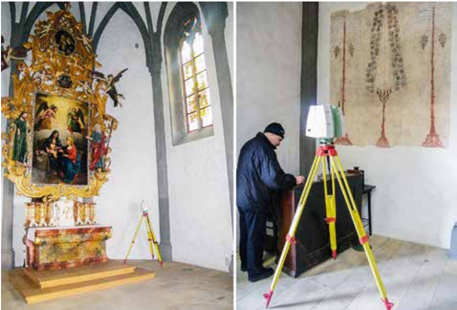
44. kép. A lézerszenner az épületen belüli 1-es és 2-es ponton (utóbbi mögött a török falkép)
