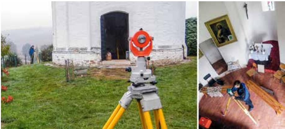
51. kép. Kényszerközpontos irány- és távmérésen alapuló technológia – bevált módszer körtemplomok szabatos felmérésére
