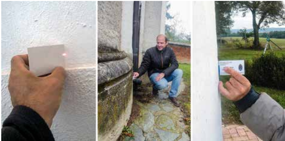
52. kép. Részletpont-mérés prizma nélküli módban, kártya és felület metszévonalára
