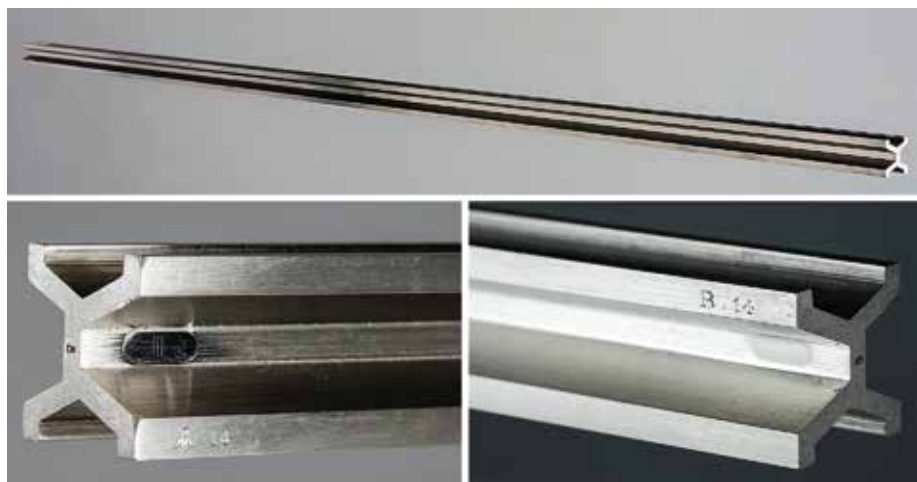
2. kép. Felül: a 14-es sorszámú méterrúd prototípus teljes hosszban (fotó: Rosta József). Alul: az A és B jelű rúdvég a három végvonással (fotó: Dabasi András). Az egykori magyar hosszetalon ma a Magyar Nemzeti Múzeum kiállítási tárgya
